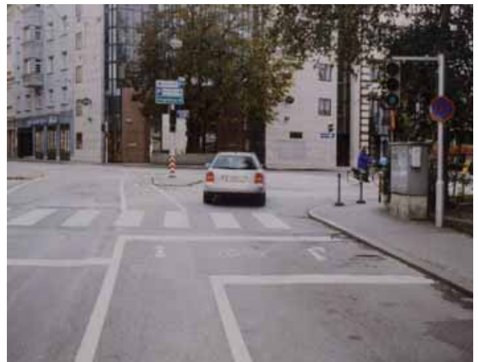
Foto 16 Linea di arresto avanzata combinata con corsia ciclabile di attestamento (Austria).
