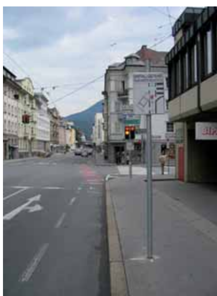
Foto 23 Segnale per gli automobilisti di attenzione ai ciclisti nelle svolte a destra (Germania).
