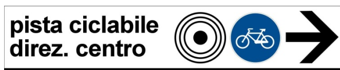
Fig 1b: Segnale "piccolo" di direzione urbano composto da fig. tab II 13/a e fig. II 90 art. 122 e fig. II 100 art. 125 DPR 495/92)
