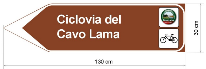
Fig 4: Segnale di direzione per avviamento a Ciclovie del Cavo Lama ottenuto dai segnali turistici per contesti extraurbani (Tabella II 14a DPR 495/92)
