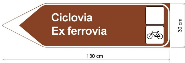
Fig 3: Segnale di direzione per avviamento a Ciclovia ex ferrovia ottenuto dai segnali turistici per contesti extraurbani (Tabella II 14a DPR 495/92)
